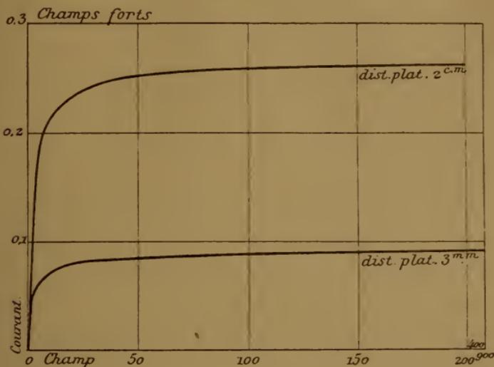
servé : 1° la *conductance initiale* pour différences de potentiel faibles; 2° le *courant limite* pour différences
